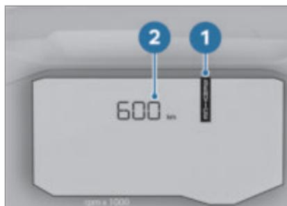
Si faltan menos de 1000 km para el próximo servicio técnico, se muestran el aviso **SERVICE 1** y el recorrido restante **2**, que se va reduciendo en intervalos de 100 km. La indicación se mostrará brevemente a continuación del Pre-Ride-Check.
