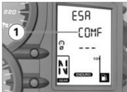
La amortiguación ajustada se visualiza en la pantalla multifunción, en la zona **1**. Los indicadores tienen el siguiente significado:
