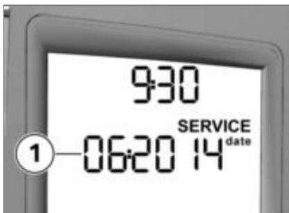
Si el tiempo restante hasta el siguiente servicio de mantenimiento es inferior a un mes, la fecha del servicio de mantenimiento **1** se muestra brevemente
