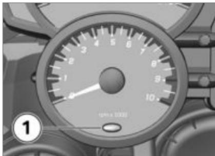
La advertencia de revoluciones indica al conductor que se ha alcanzado el área roja de la gama de revoluciones. Esta señal se representa mediante el parpadeo de la advertencia de revoluciones **1** en rojo.
