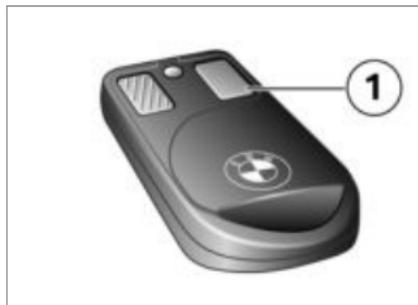
La duración de la señal de alarma es de 26 segundos. Transcurridos otros 12 segundos, el sistema vuelve a estar activado. Una vez que el tono de alarma se haya activado, puede interrumpirse en cualquier momento pulsando la tecla **1** del mando a distancia. Esta función no cambia el estado de la alarma antirrobo.
